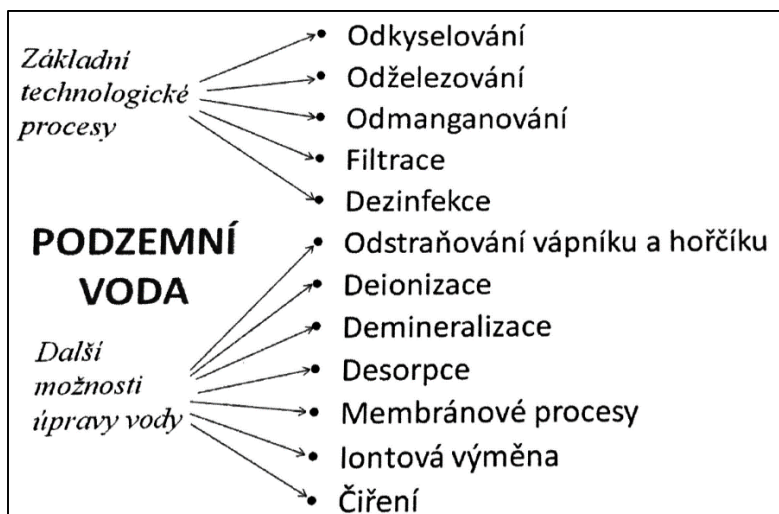
Obr. 5: Technologické procesy úpravy podzemní vody [18]
