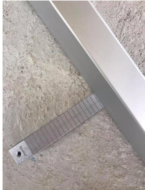
Obrázek 45 – Měření místní rovinnosti detail – archiv autora
