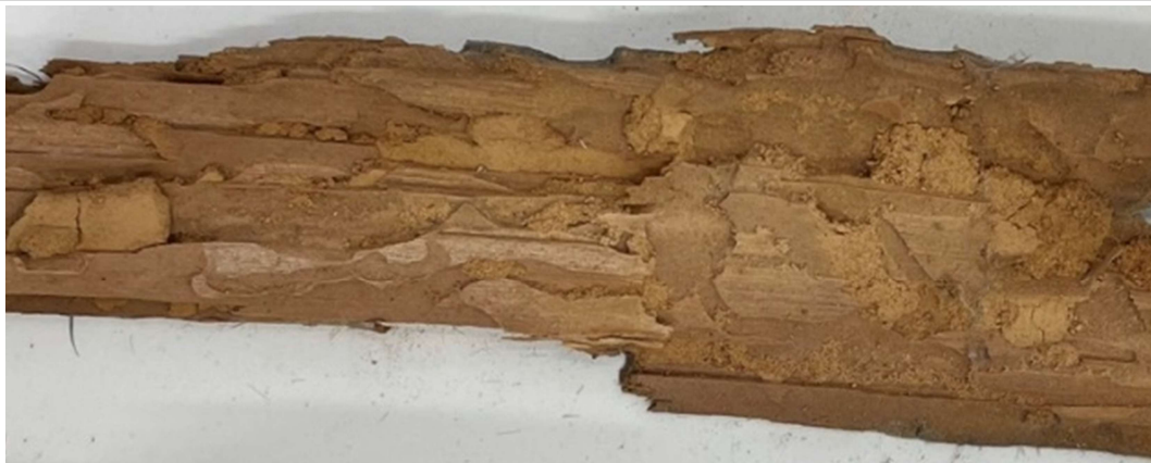
Obr. 53: Stopy po působení tesaříka
