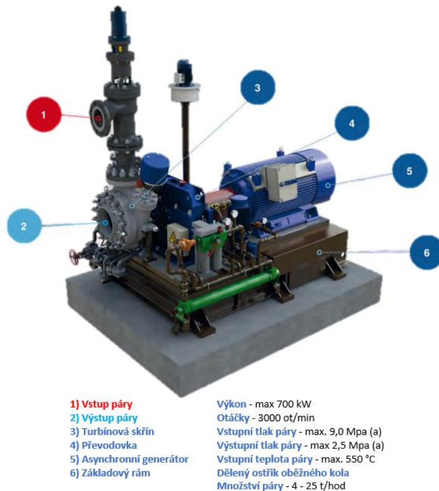
Obrázek 12: Točivá redukce TR 320 [3]
