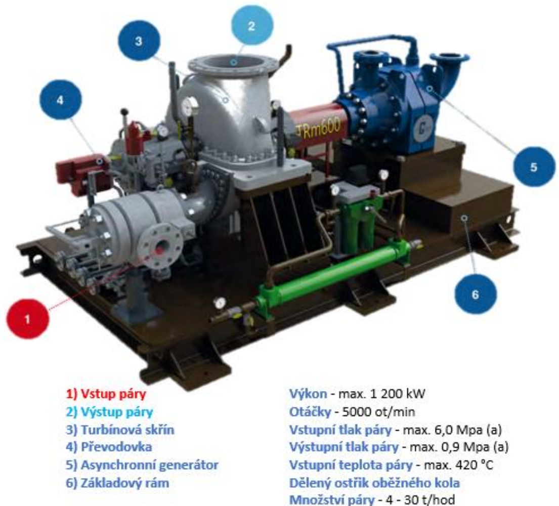
Obrázek 14: Točivá redukce TRm [3]
