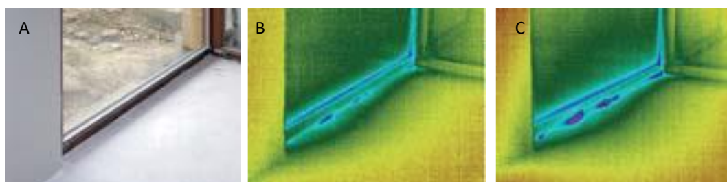
Obrázek 4: Detekce netěsností termovizního snímkování z interiéru, převzato z [11]
