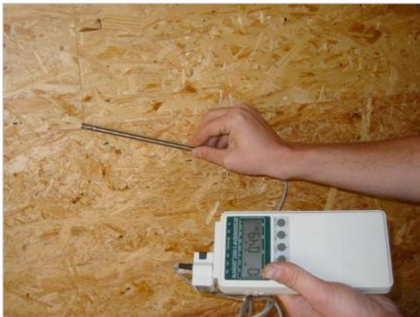
Obrázek 3: Lokalizace netěsností anemometrem, převzato z [6]
