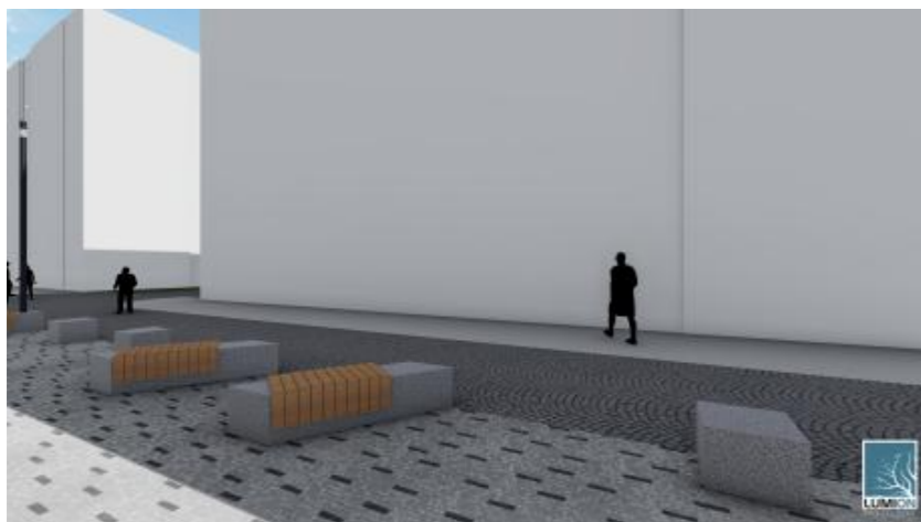
Bariéry pro automobilovou dopravu, žulové kvádry, lavičky ze žuly a dřeva
