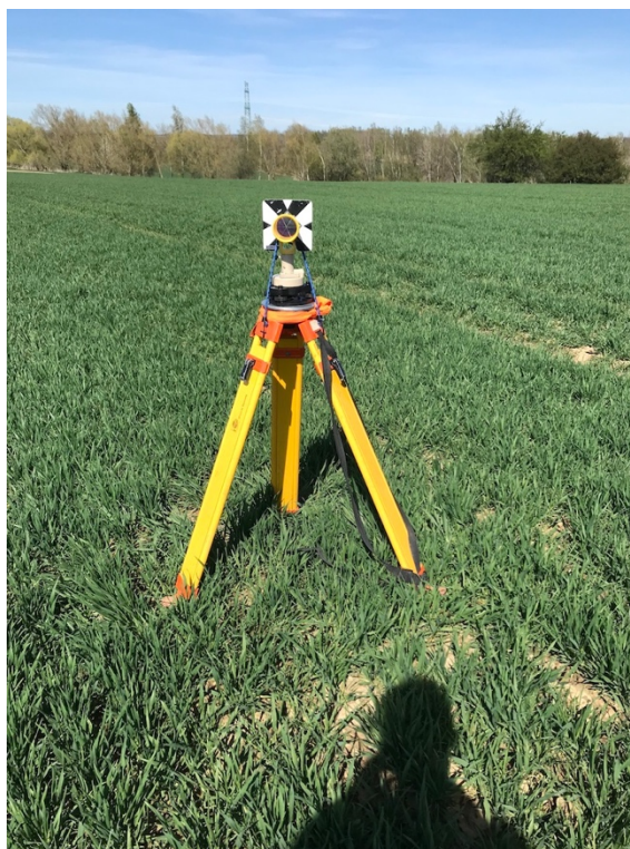
Obr 23: Cíl 5 - testování totální stanice
