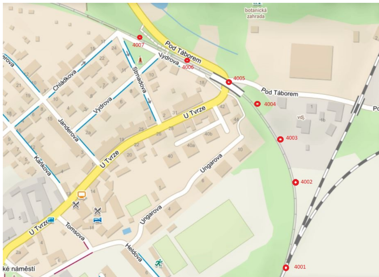
Obr 25: Přehledka bodů polygonového pořadu [19]
