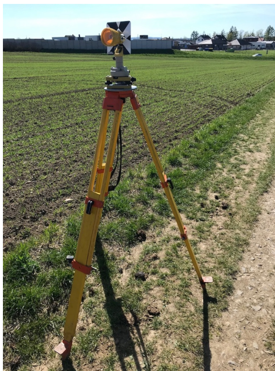
Obr 21: Cíl 3 - testování totální stanice
