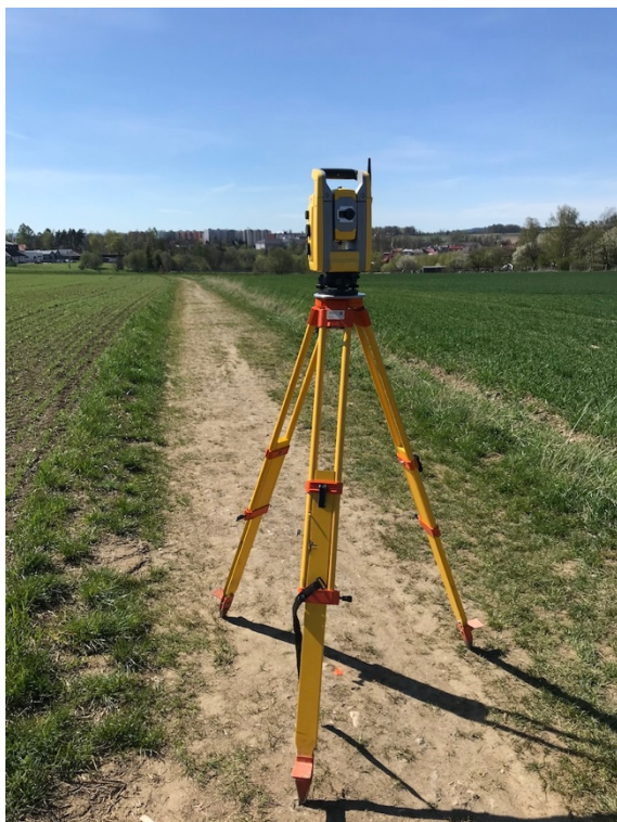
Obr 18: Stanovisko - testování totální stanice
