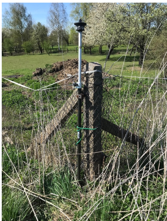
Obr 22: Cíl 4 - testování totální stanice
