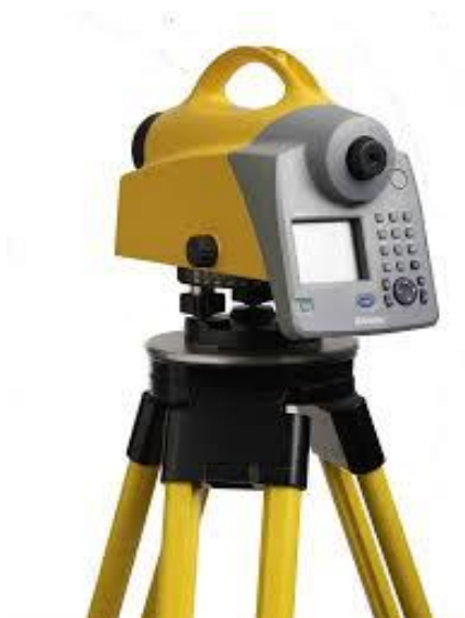
Obr. 7 Digitální nivelační přístroj Trimble DiNi
