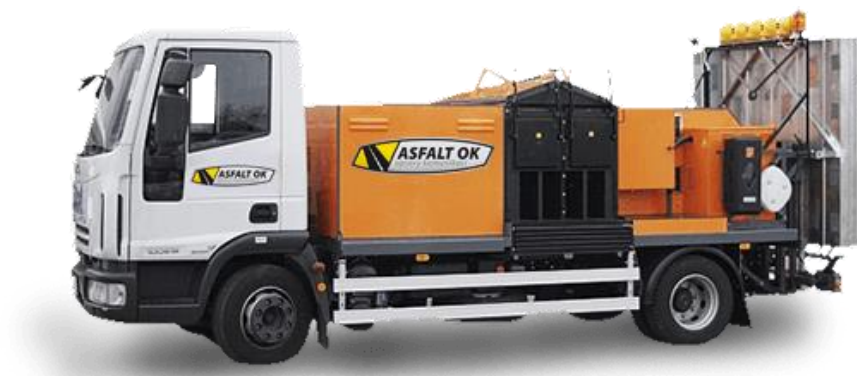
Obrázek č. 22 – Nákladní vozidlo s nástavbou pro opravování výtluků metodou ITHR. Zdroj [14]
