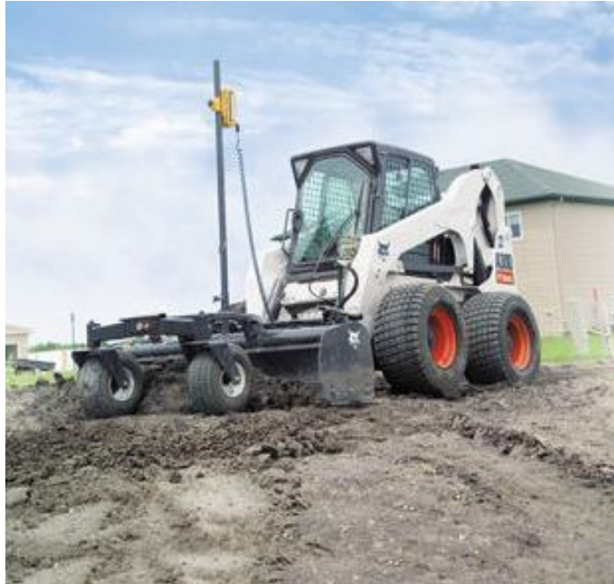
Obrázek č. 23 – Ukázka příslušenství box blade. Zdroj [23]
