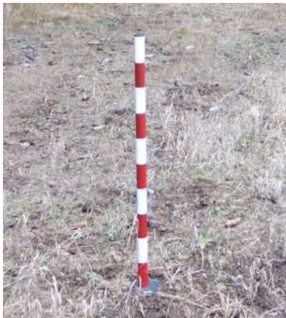
Obr. 13 – Sněhoměrná lať na stanovišti Smrk 975
