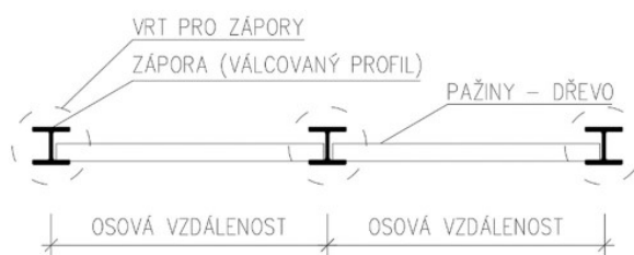
Obr. 33 Půdorysné uspořádání záporového pažení
