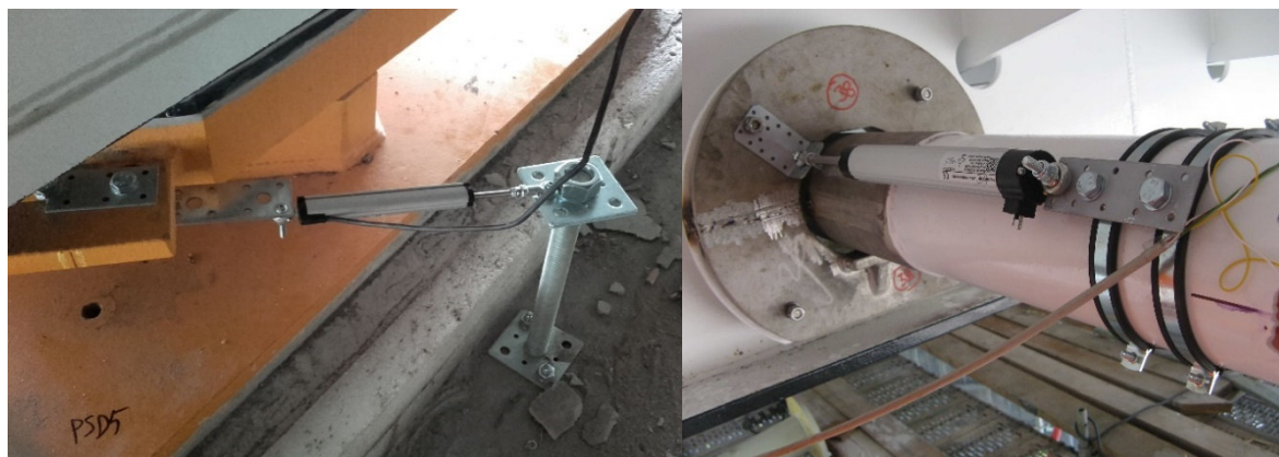
Obr. 32: Vlevo snímač posunu mostu v ložiskách PSD5, vpravo snímač posunu ŘT PSD10
