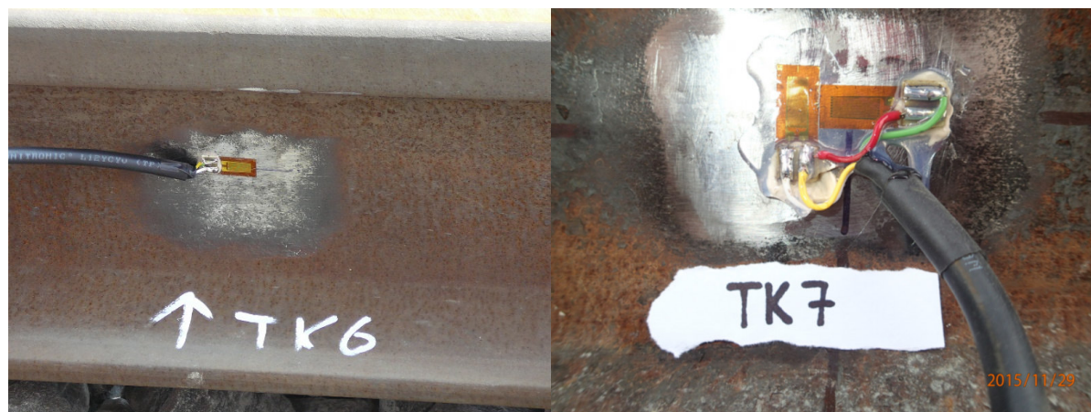
Obr. 30: Vlevo tenzometr TK6 (čtvrtmost), vpravo TK7 (polomost)
