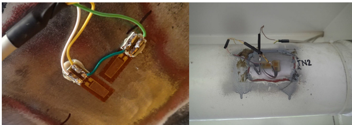
Obr. 31: Vlevo tenzometry na řídicí tyči TN2 (další 2 tenzometry jsou umístěny z druhé strany), vpravo tenzometry na koncovém příčniku TN6
