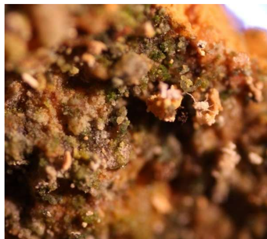
Obr. 58 – vzorek interiérové cihly pod mikroskopem (pořízeno v rámci bakalářské práce odbornou pracovníci laboratoře)
