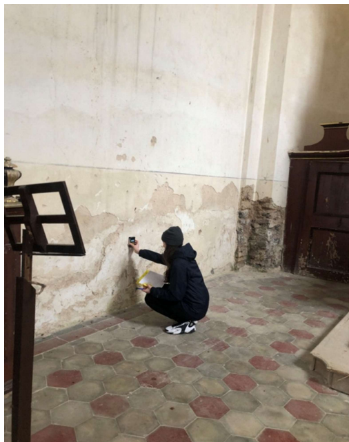
Obr. 38 – měření vlhkosti vlhkoměrem
