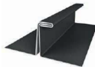
Obrázek 7 - Detail - dvojitá stojatá drážka [9]
