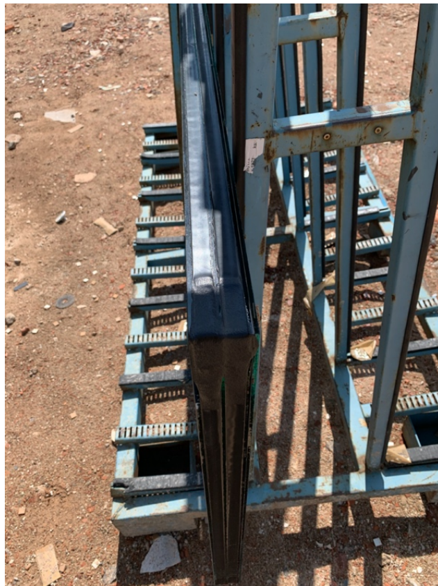
Obr. 6 – Detail tmelení izolačních skel
