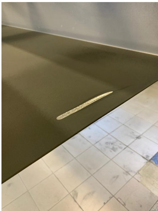
Obr. 23 – Detail setření nezapečeného práškového laku
