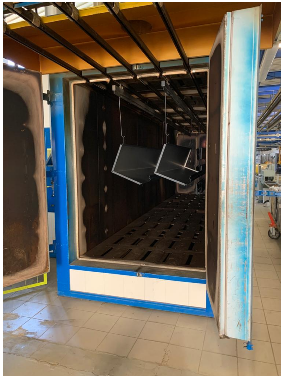
Obr. 26 – Pohled do zapékací pece v práškové lakovně
