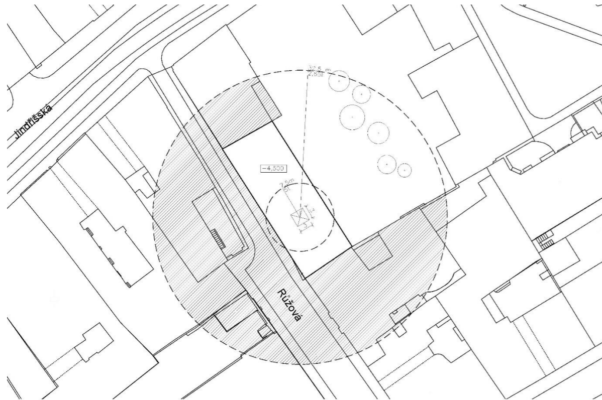
Schéma situace s jeřábem a vyznačením zákazu manipulace s břemenem
