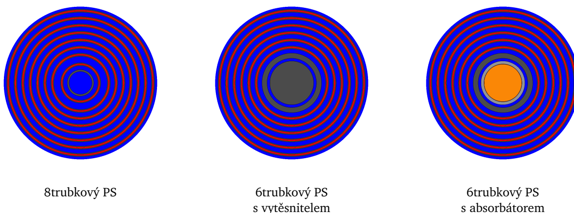
Obr. 2.1: Geometrie PS IRT-4M v kódu WIMS-ANL; palivo – červeně, pokrytí – šedě, moderátor – modře, absorbátor – žlutě
