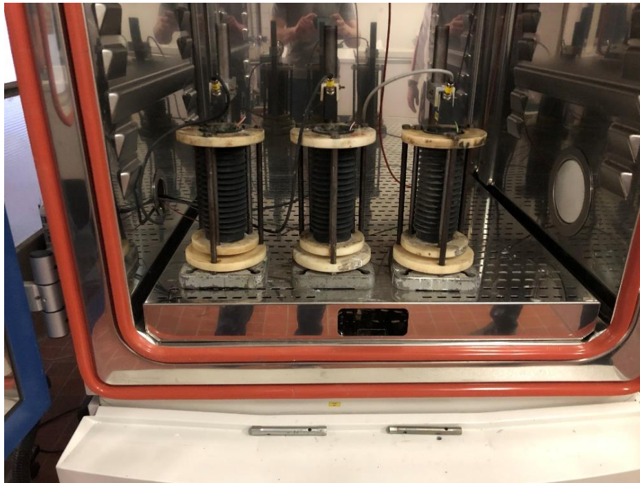
Obr. 23: Umístění vlnoců v termostatu
