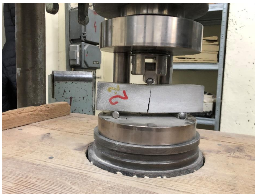
Obr. 18: Porušení vzorku po zkoušce v tahu ohybem
