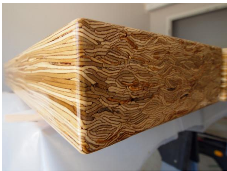
Obr. 2: Pohled na strukturu dřevěného kompozitu Parallam [4]
