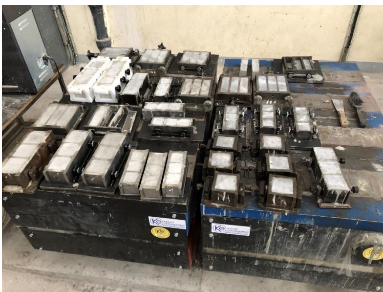
Obr. 15: Vybetonované vzorky před odbedněním
