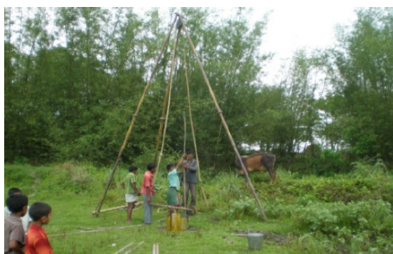
Obrázek 5.3: Sběr půdních vzorků pomocí metody vrtání [77]
