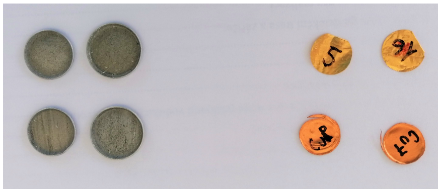
Obrázek 6.15: Zlaté a měděné aktivační fólie a kadmiové pokrytí
