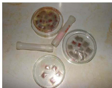
Obrázek 5.4: Připravené vzorky půd těsně před ozařováním v poli neutronů [77]
