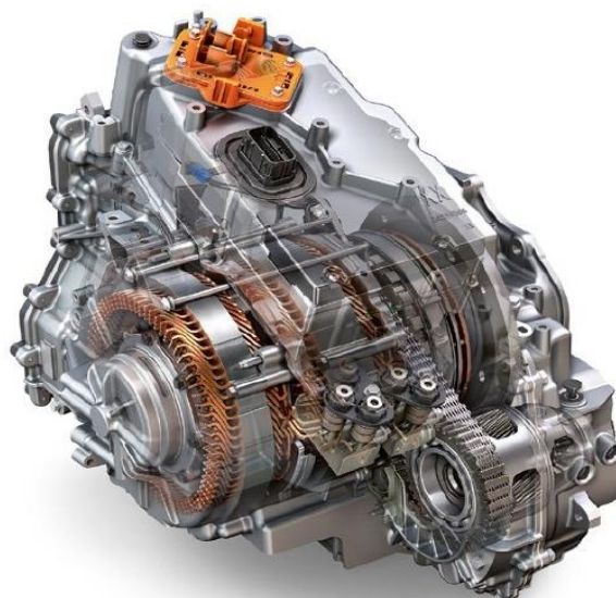
Obrázek 19: Převodové ústrojí systému Volt II [29]
