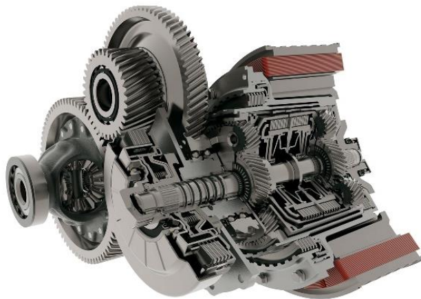
Obrázek 12: Konstrukce DHT převodovky [25]
