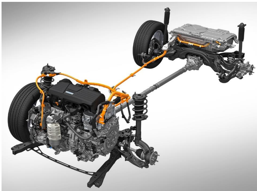
Obrázek 15: Hnací ústrojí Honda CR-V Hybrid [27]
