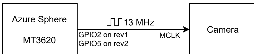
■ Obrázek 3.4 Zapojení hlavního hodinového signálu kamery
