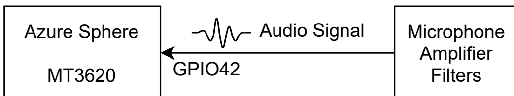
■ Obrázek 3.10 Zapojení mikrofonu
