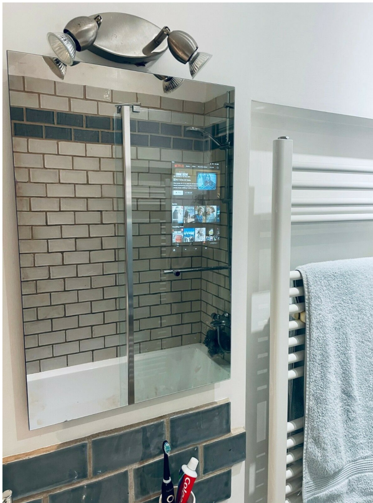
■ Obrázek 2.7 Bezrámečkové chytré zrcadlo s elegantním designem a tenkým provedením (takřka nerozeznatelné od běžného koupelnového zrcadla); o informace se stará tablet s OS Android a aplikací chytrého zrcadla, kterou poskytuje výrobce [13]
