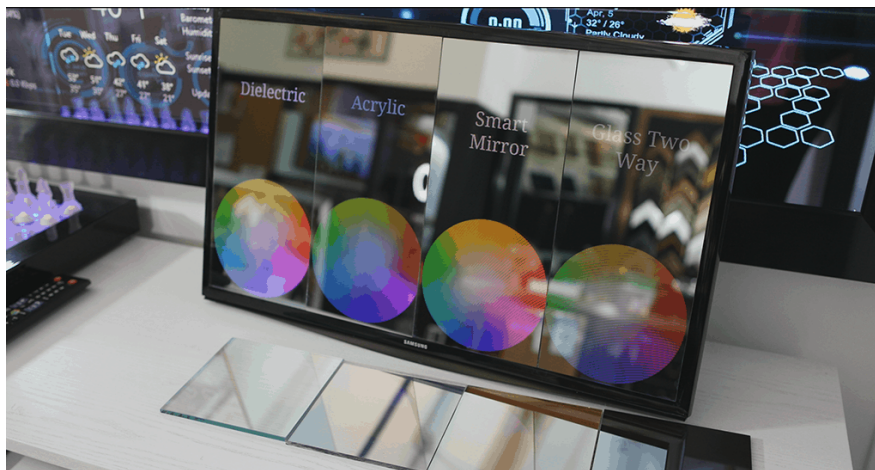
■ Obrázek 2.10 Porovnání zobrazení barevného kolečka a jednoduchého bílého nápisu zobrazených stejným displejem skrz čtyři různá skla. Zleva: dielektrické, akrylové, sklo pro chytré zrcadlo a polopropustné sklo [16]
