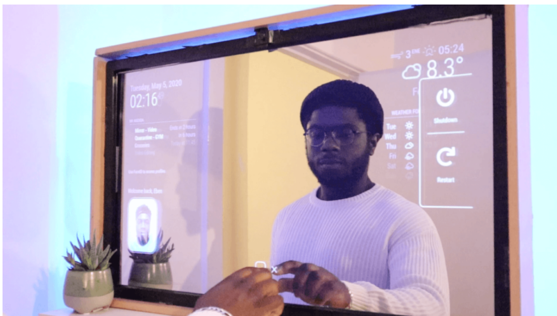
■ Obrázek 2.4 Dotykové chytré zrcadlo s FaceID, které díky obrazu z kamery a využitím platformy OpenCV detekuje obličej a nastaví podle toho profil uživatele, či provede nějakou akci [11]
