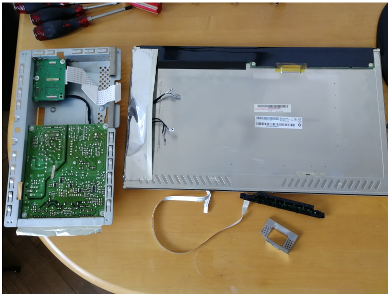
■ Obrázek 3.3 Rozebraný monitor bez okolního plastu
