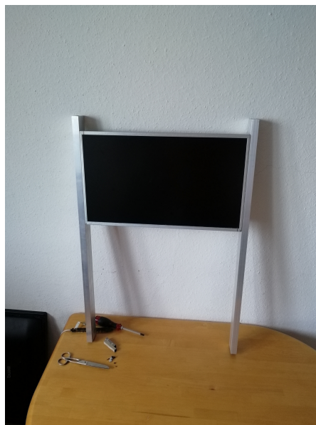
■ Obrázek 3.4 Uchycení monitoru k nosným profilům
