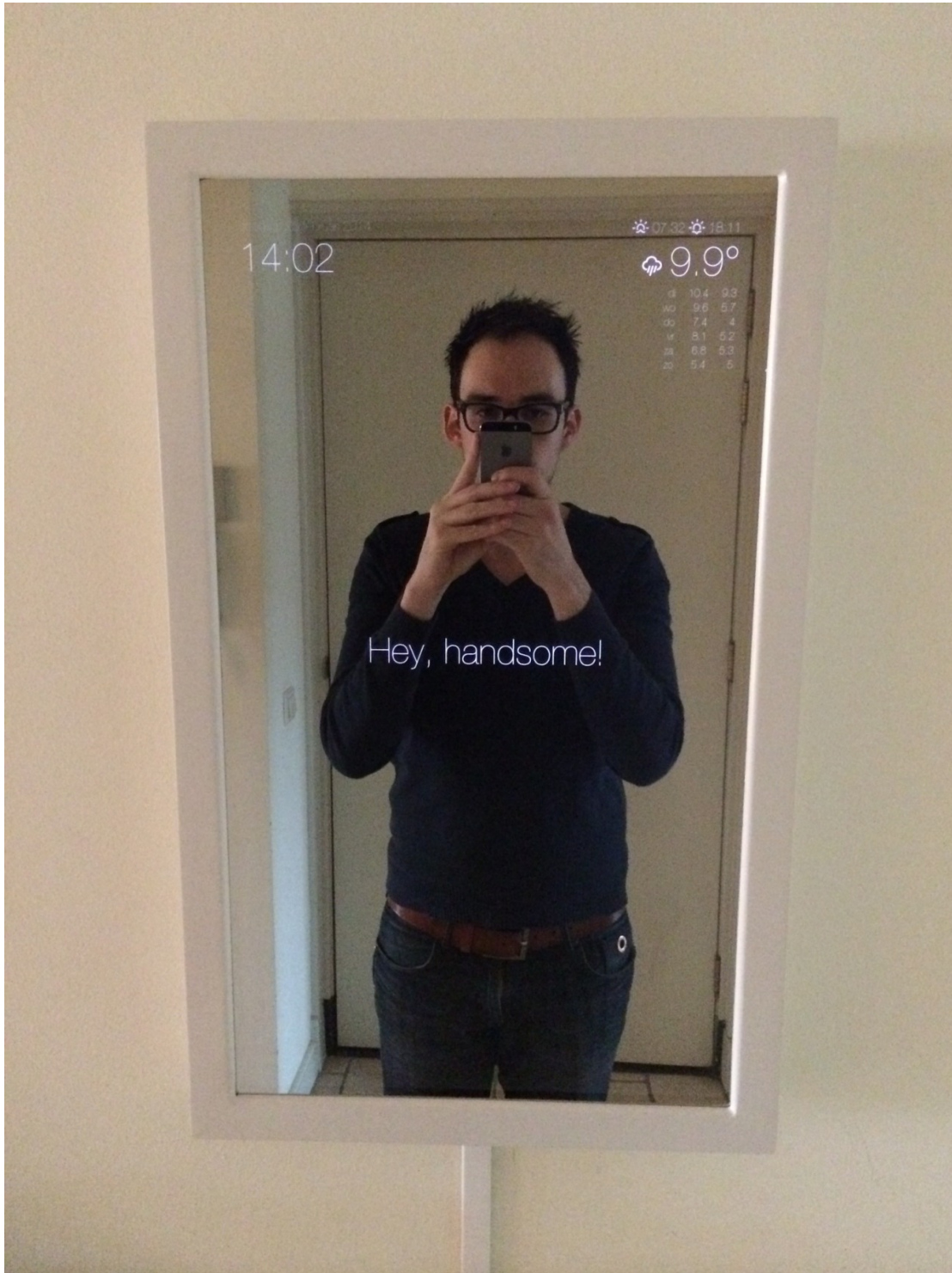
■ Obrázek 2.1 Původní chytré zrcadlo od zakladatele platformy MagicMirror 2 , Michaela Teeuwa, které zobrazuje čtyři základní údaje – kompliment, počasí, hodiny s kalendářem a novinky ze zpráv [7]
