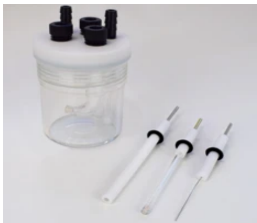
Obrázek 2.6: Elektrochemická cela s elektrodama, převzato z [14]
