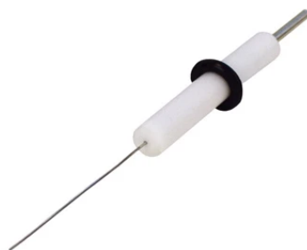
Obrázek 2.5: Pomocná elektroda, převzato z [14]
