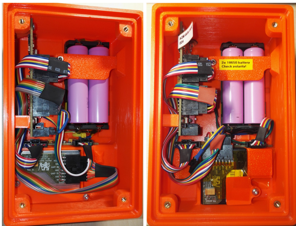
Obrázek 41: Fotografie finálních jednotek pro měření kvality ovzduší - pohled dovnitř, vlevo senzor Amphenol, vpravo senzor Honeywell
