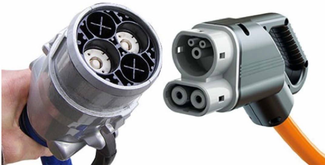
Obrázek 3 - DC dobíjecí standardy CHAdeMO (vlevo) a CCS Combo (vpravo) [46]
