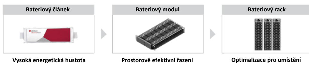
Obrázek 6 - Skladba bateriového systému [55]
