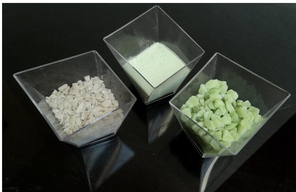
Obr. 4.1: Svítící kamenivo a příměs za světla
