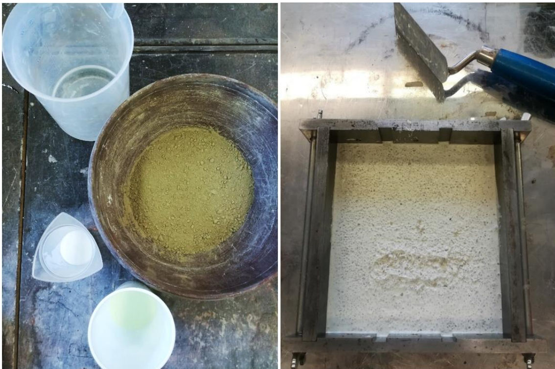
Obr. 4.9: Výroba vzorků s šedým a bílým cementem
