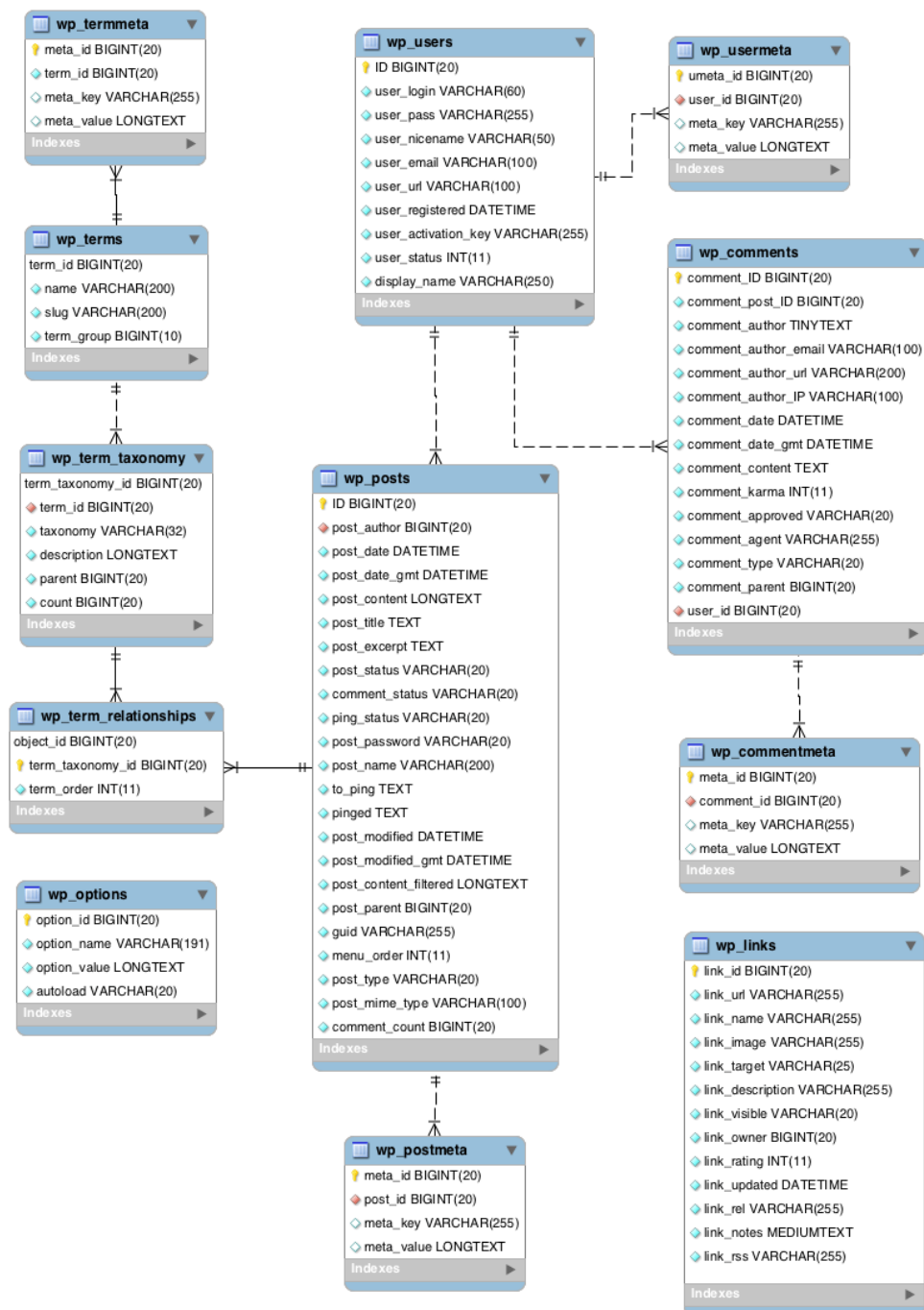
Obrázek B.1: Databázový diagram systému WordPress [1]
