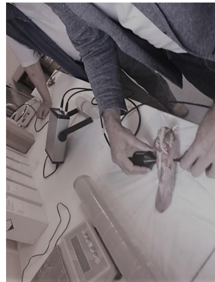
Obr. 65 ultrazvukový neinvazivní měřicí přístroj fy Proceq a jeho kalibrace na vepřovém jazyku
