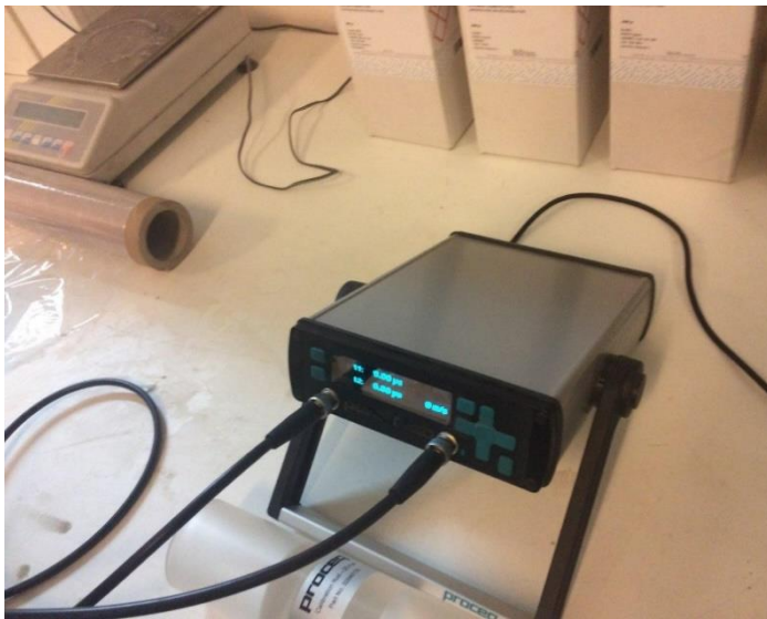
Obr. 65 ultrazvukový neinvazivní měřicí přístroj fy Proceq a jeho kalibrace na vepřovém jazyku
