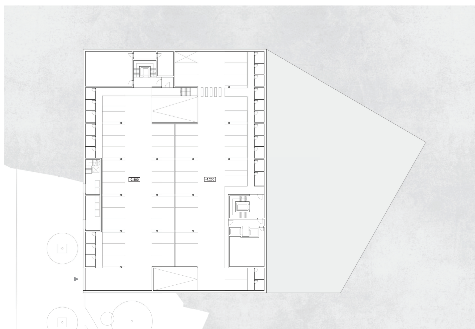
1 PP Podzemní garáže. Sklepy a technické místnosti.
