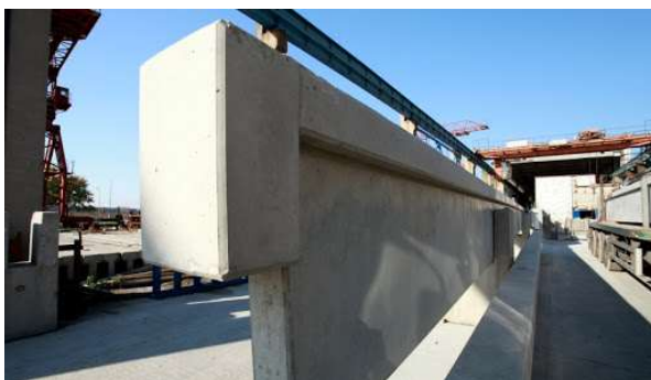
Obrázek 9 - železobetonový T vazník [21]
