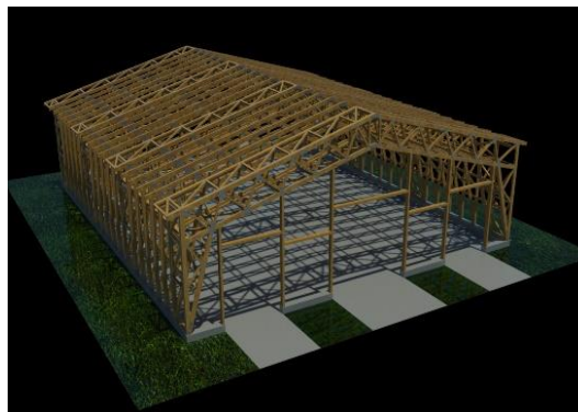
Obr. 24 - Příhradový dřevěný rám [31]
