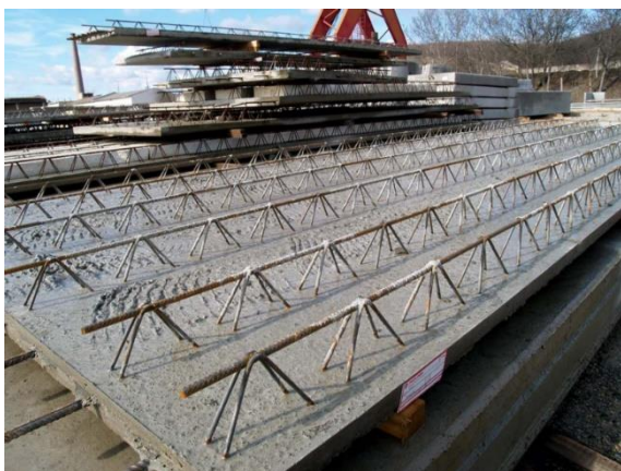
Obr. 49 - Prefamonolitický stropní panel typu Filigran [45]
