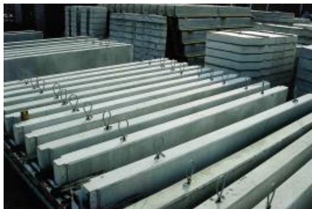
Obr. 59 - Betonové prvky s našroubovanými závěsy [47]
