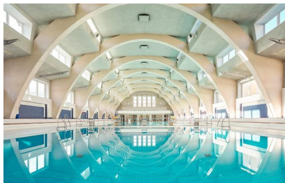
Obr. 42 - Plnostěnný rovinný železobetonový oblouk - plavecký bazén [43]
