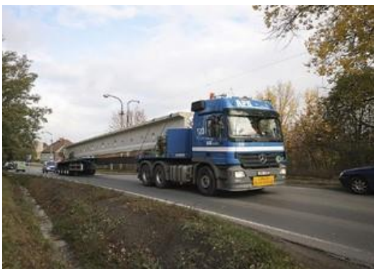
Obr. 53 - Přeprava vazníku po veřejných komunikacích [46]
