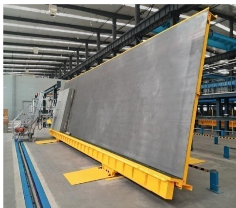
Obr. 48 - Bednicí stůl pro betonáž prefabrikátů [44]
