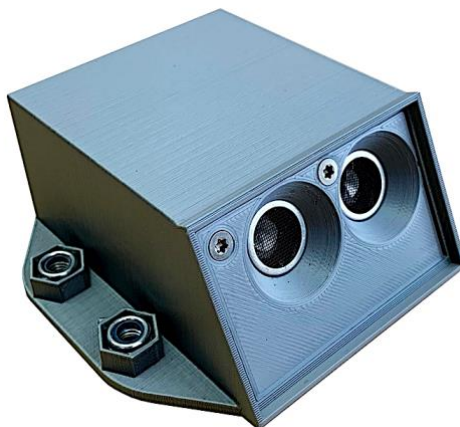
Obrázek 22 - Vyrobený kryt měřící jednotky se senzorem
