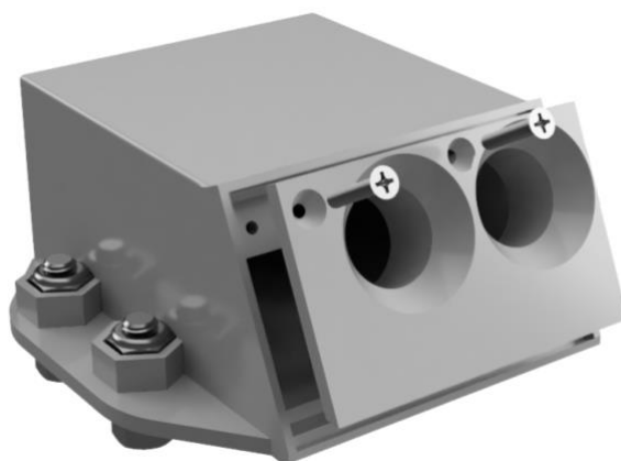
Obrázek 19 - 3D model krytu elektroniky
