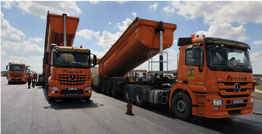
Obrázek 11 - Nákladní vozidla určená k přepravě asfaltové směsi; stavební firma Froněk [15]
