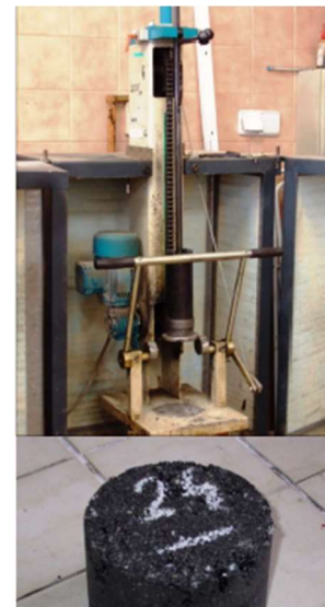
Obrázek 5 - Marshallova zkouška – lis a zkušební těleso [6]
