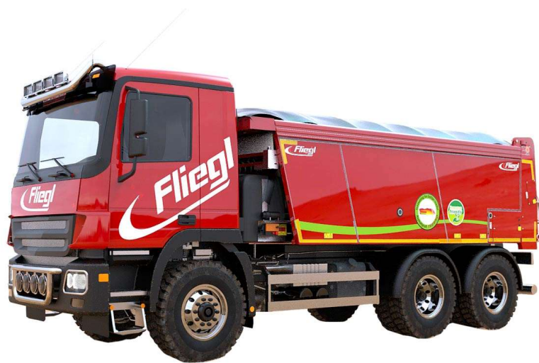
Obrázek 14 - Speciálně izolované nákladní vozidlo s krytem od firmy Fliegl Baukom [17]
