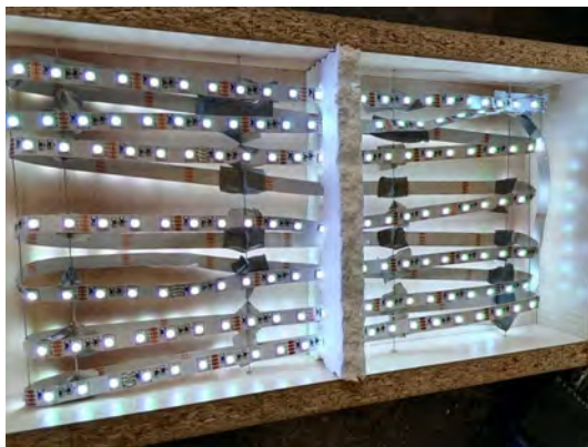
Obrázek 50: Forma s umístěnými LED diodami
