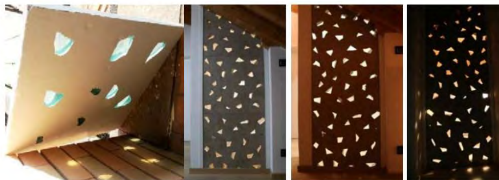
Obrázek 14: Příklady konstrukcí s využitím odpadního skla [26]
