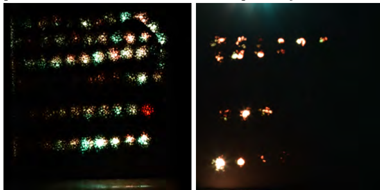
Obrázek 53: Fotografie z temné komory těles s drceným sklem respektive kombinací drceného skla a plastových vláken
