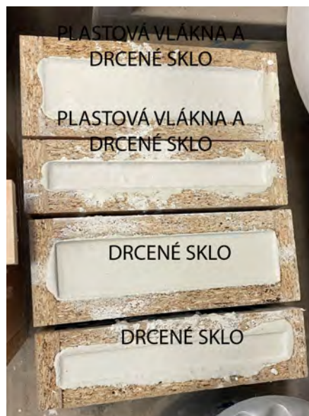
Obrázek 37: Vybetonované formy B2 a B3
