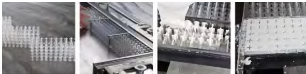
Obrázek 13: Postup výroby betonu LiCrete [25]
