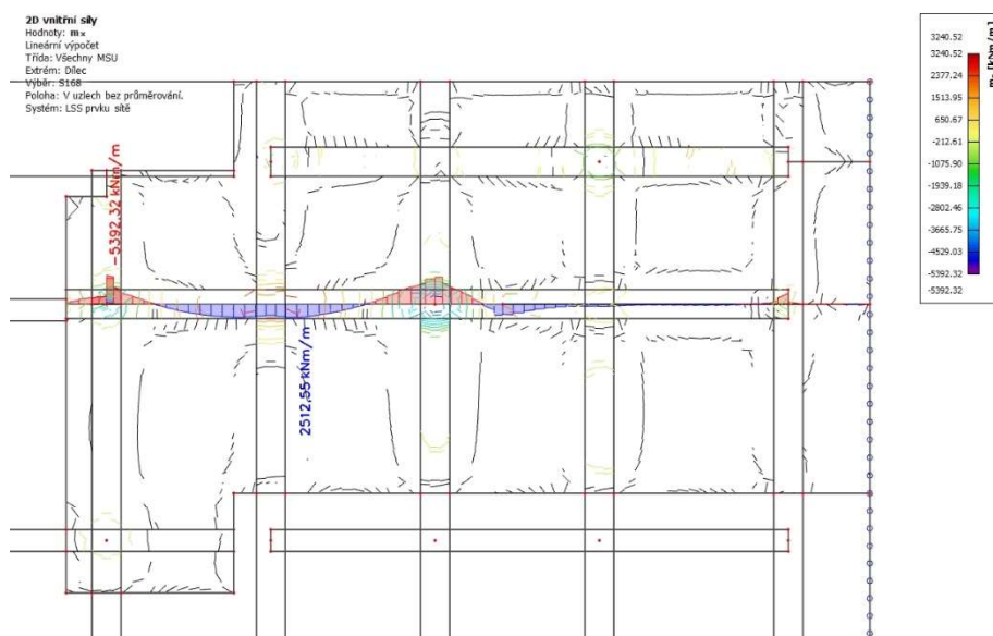
Obrázek 37 - Zobrazení ohybového momentu M_y s maximálními hodnotami na nejvíce zatíženém průvlaku od kombinace pro MSÚ (model 2) [10]
