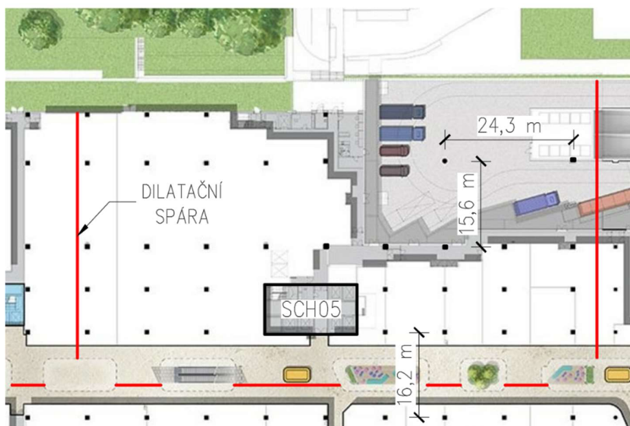
Obrázek 16 - Dispoziční schéma 1NP s vyznačenými maximálními rozpony a ztužujícím jádrem [26; 28]
