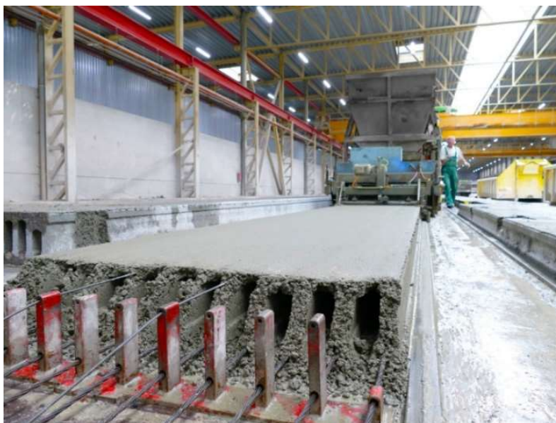
Obrázek 3 - Technologie předem předpjatého betonu – dlouhá linka [20]
