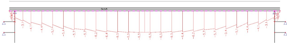
Obrázek 70 – Normálové napětí na konci životnosti – MSP častá kombinace 1 – horní vlákna nosníku
