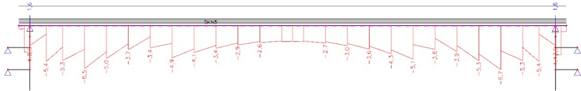
Obrázek 71 – Normálové napětí na konci životnosti – MSP častá kombinace 1 – dolní vlákna nosníku
