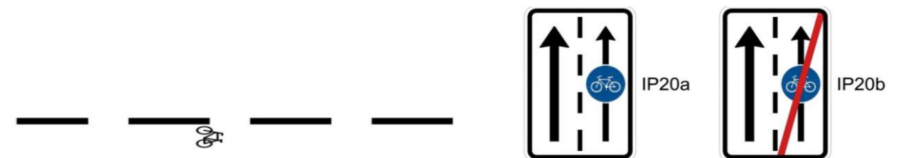
Obrázek 14: Schéma a značení vyhrazeného pruhu pro cyklisty (Zdroj: TP179 - Navrhování komunikací pro cyklisty – Dostupné z: http://www.pjpk.cz/data/USR_001_2_8_TP/TP_179_2017.pdf )
