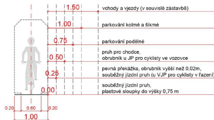
Obrázek 22: Odstupové vzdálenosti mezi jízdním pruhem pro cyklisty a překážkou (Zdroj: TP179 - Navrhování komunikací pro cyklisty – Dostupné z: http://www.pjpk.cz/data/USR_001_2_8_TP/TP_179_2017.pdf )
