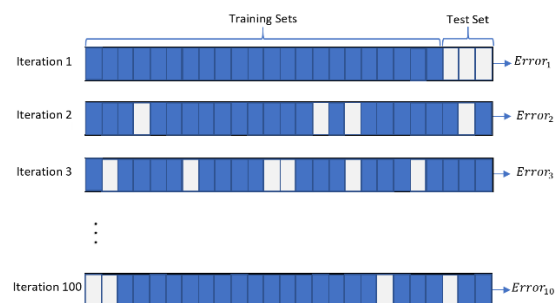
Obr. 20 Schéma Monte Carlo křížové validace [30]
