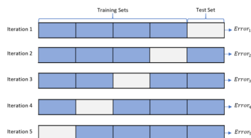
Obr. 19 Schéma K-násobné křížové validace [30]
