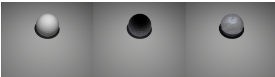
Obrázek 6.7: Vlevo je scéna se základní texturou, slouží pro představu nasvícení, uprostřed se nachází špatně vykreslovaná BTF textura a vpravo je opravené vykreslování, tedy již se volá funkce eval .
