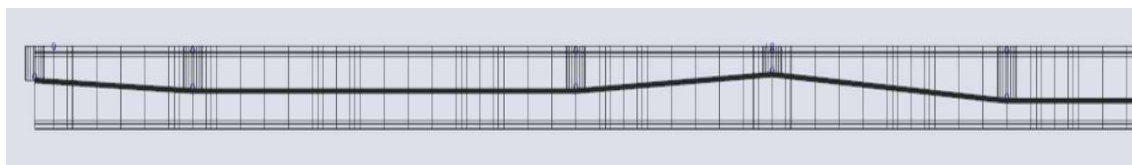
Obrázek 58 - Předpínací kabely ve výpočetním modelu - varianta 2
