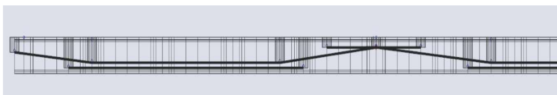
Obrázek 46 - Předpínací kabely ve výpočetním modelu (ideální kabely)
