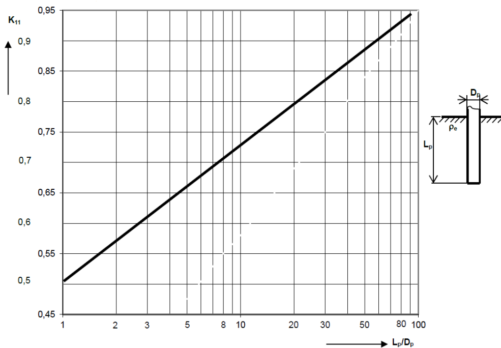
Obr. 4.8: Určení koeficientu K_{11} 124
