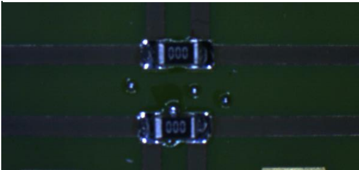
Příloha 11: Pájecí pasta 1 na desce mezi odpory
