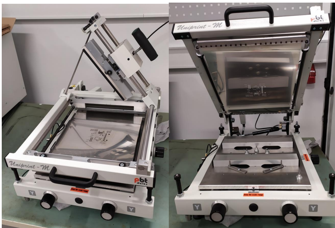
Obrázek 11: Sítotisk s napnutou šablonou
