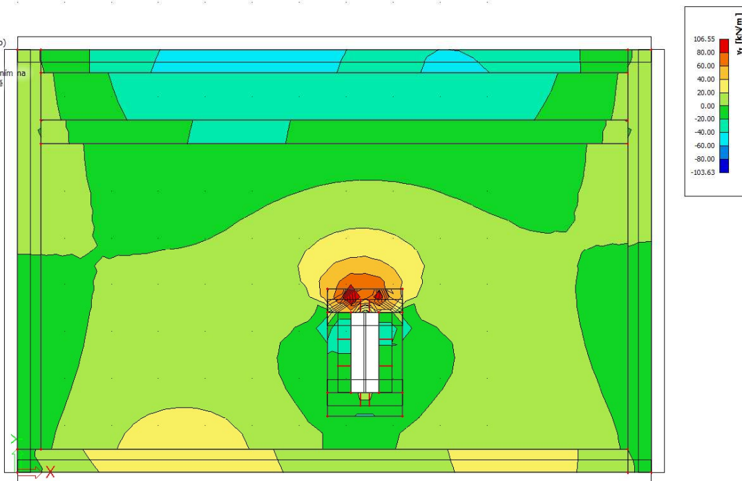
Obr. 5.17: Průběh posouvající síly ve směru Y z programu SCIA Engineer
