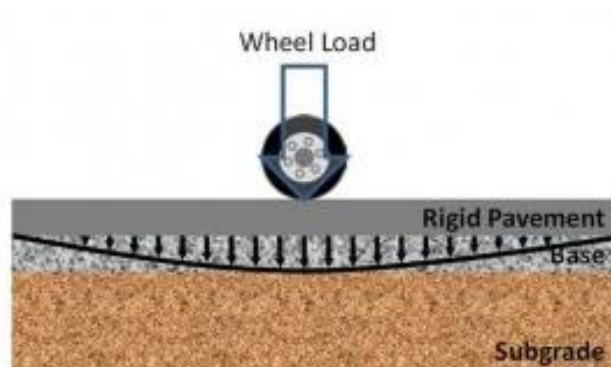
Obr. 18: Rozložení napětí v cementobetonové vozovce [20]
