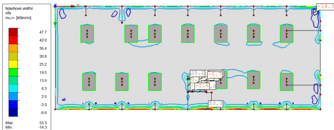
Obr. 84 – m_{y+} základové desky od charakteristických hodnot zatížení v kladném směru lokální osy z
