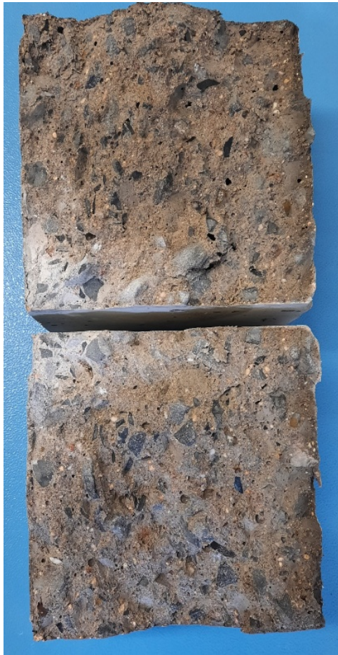
Obr. 56 – vzorek Lab0 po zkoušce tlakovou vodou
