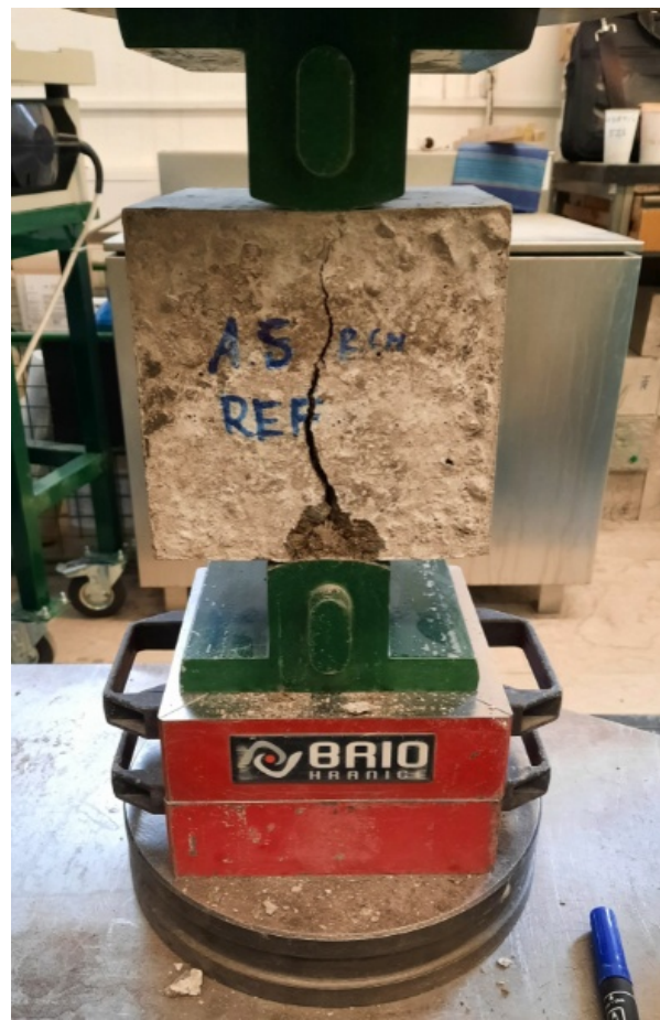
Obr. 51, 52 – zkouška pevnosti v příčném tahu
