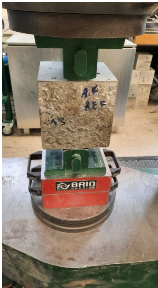
Obr. 51, 52 – zkouška pevnosti v příčném tahu
