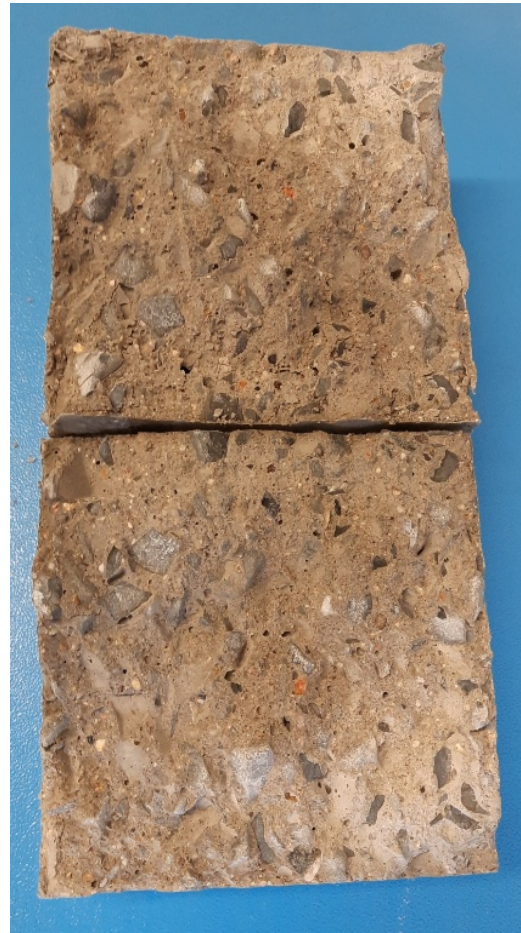
Obr. 57 – vzorek Lab3 po zkoušce tlakovou vodou
