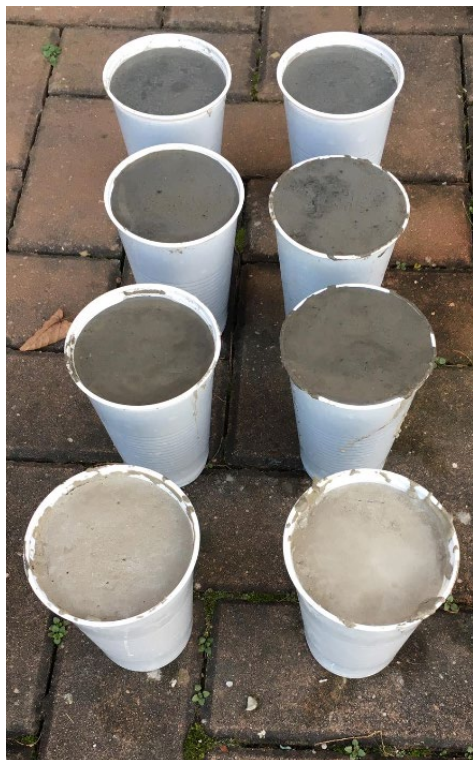
Obr. 34 – čerstvě vybetonované vzorky (ze shora: Dom0, Dom2, Dom3, DomK)
