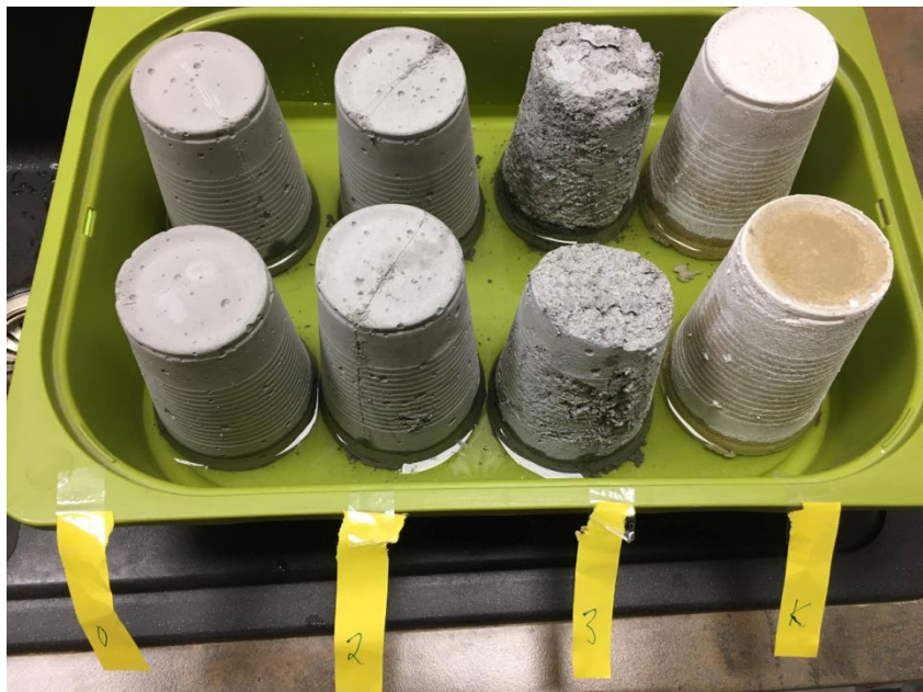
Obr. 36 – vyschlé vzorky po uložení do vody (zleva: Dom0, Dom2, Dom3, DomK)
