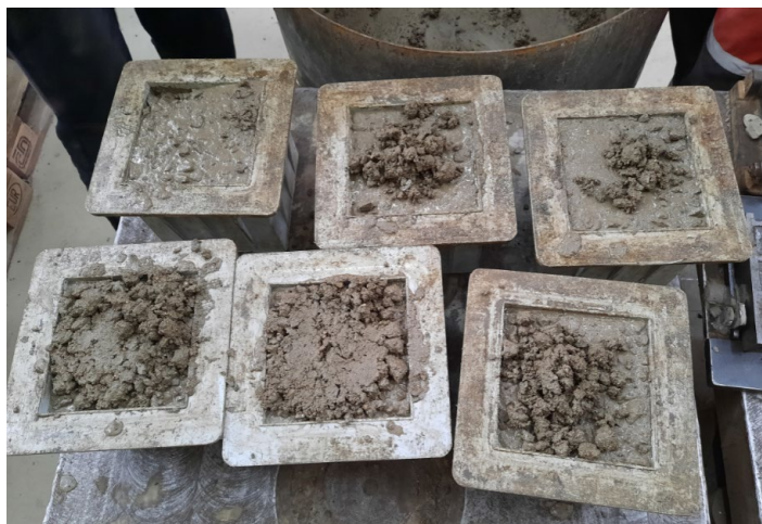
Obr. 44 – čerstvý beton po uložení do forem
