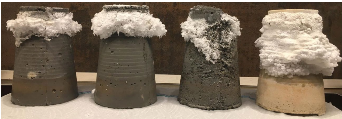
Obr. 40 – vzorky po 3 měsících ve vodě – 11. 5. 2021 (zleva: Dom0, Dom2, Dom3, DomK)
