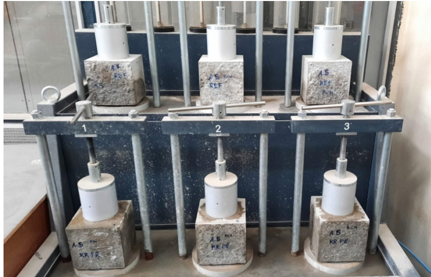
Obr. 55 – zkouška tlakovou vodou na vodotlačné stolici
