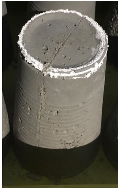
Obr. 38 – vzorek směsi Dom2 po 4 dnech ve vodě – růst krystalů
