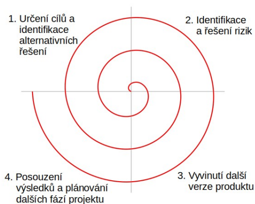
Ilustrace 3: Spirálový model. In: WikiMedia Commons [online]. WikiMedia, 2006. [vid. 12. 4. 2021] Převzato a upraveno z: https://commons.wikimedia.org/wiki/File:Archi_medean_spiral.svg Dále upraveno dle: https://searchsoftwarequality.techtarget.com/definition/spiral-model
