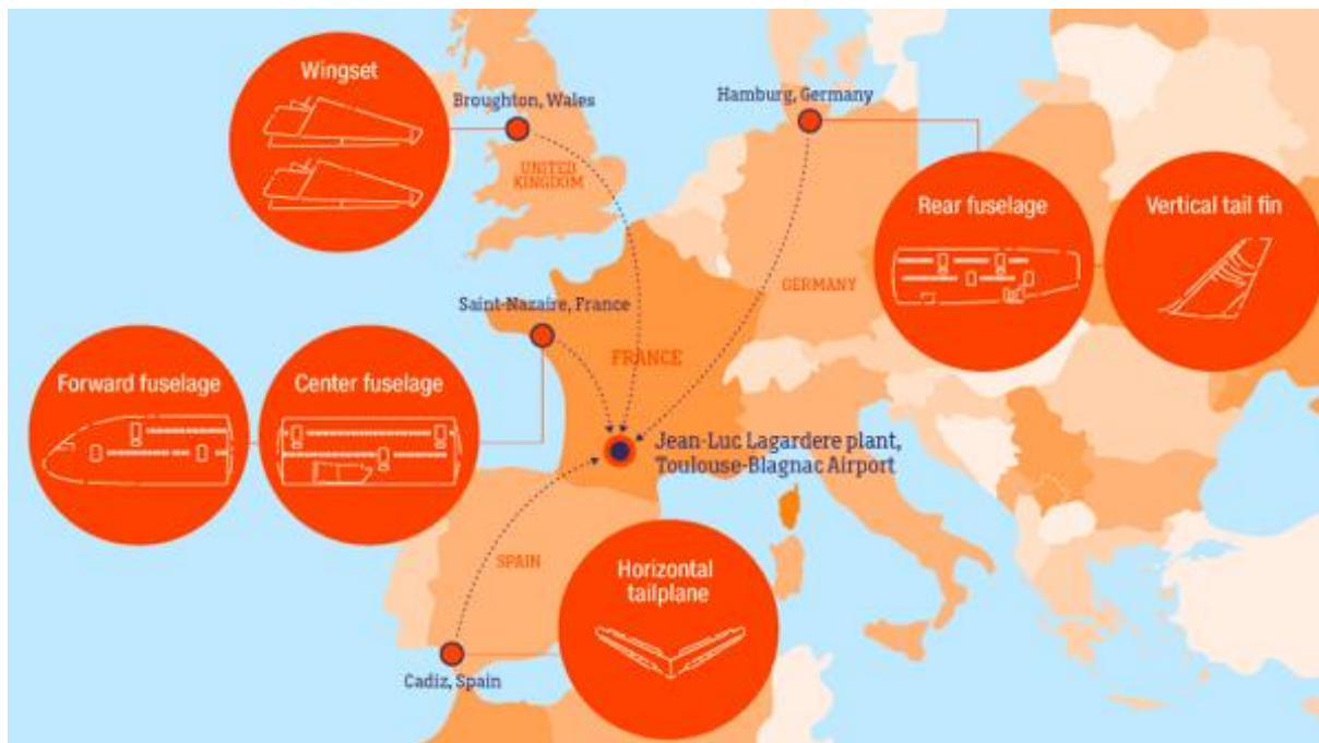
Obrázek 6 – výrobní proces Airbusu A380 [20]
