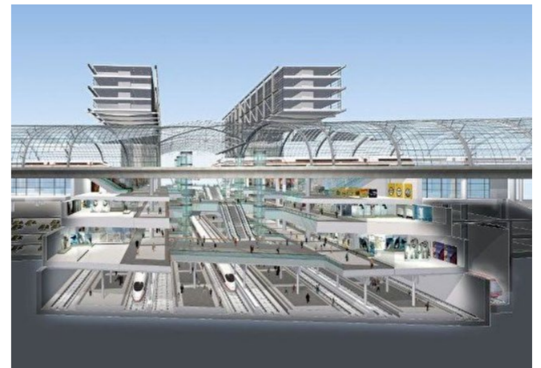
50 Nástupiště se nachází nad a pod odbavovací halou.
