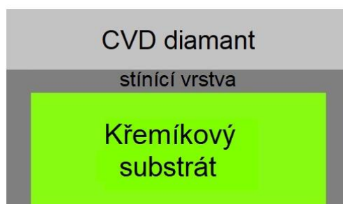
Obr. 4.1 Schéma deponovaných vrstev na substrátu křemíku s využitím stínící diamantové vrstvy.
