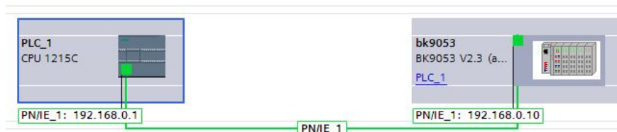
Obrázek 92: Propojení PLC a rozšiřující I/O
